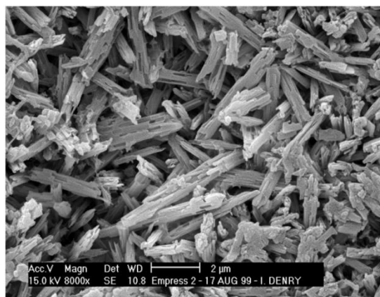
Microstrostruktur av presset lithium disilicate glass-ceramic, eks Empress eller IPS eMax, viser overvekt av lithium di-silikat krystaller.
